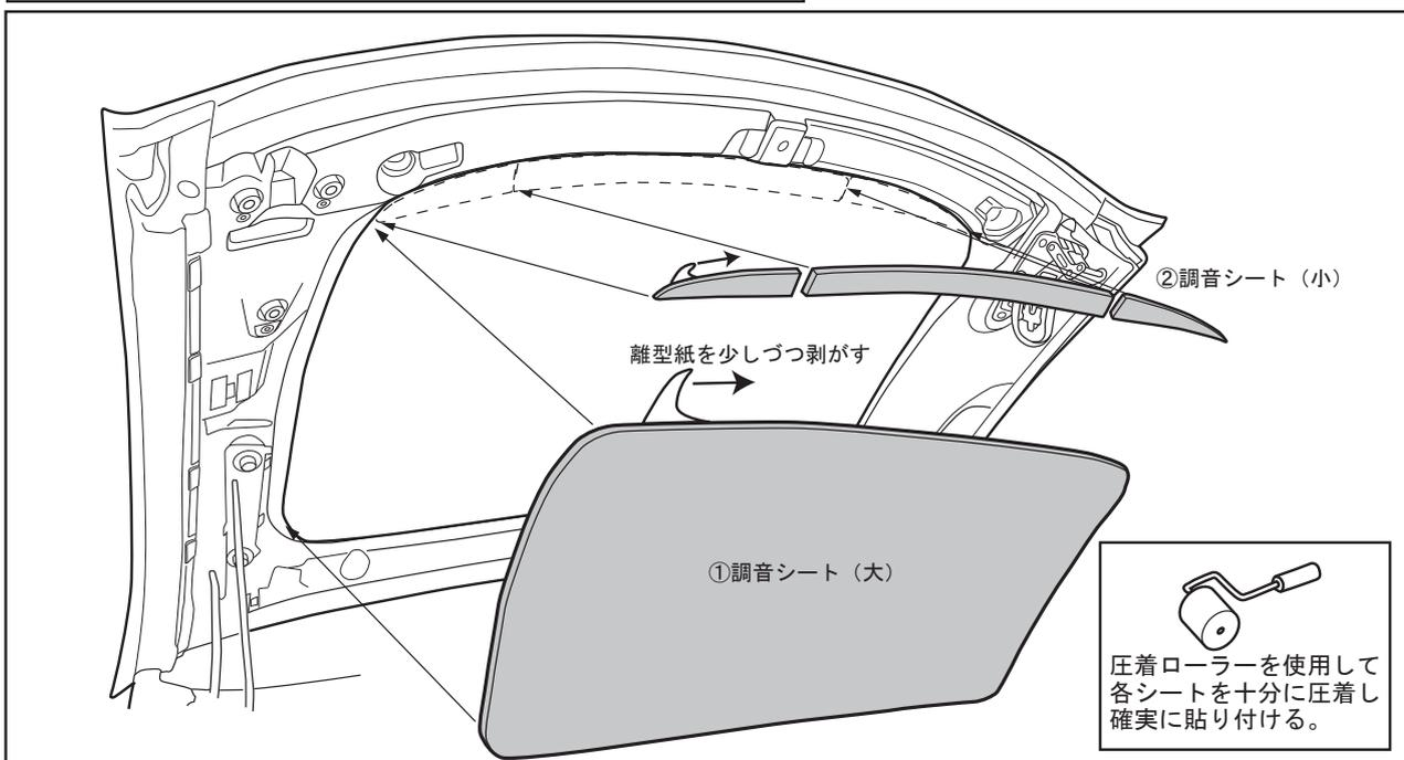
4. 車両ルーフの調音シート貼り付け面を全面きれいに清掃して、十分に脱脂してください。
